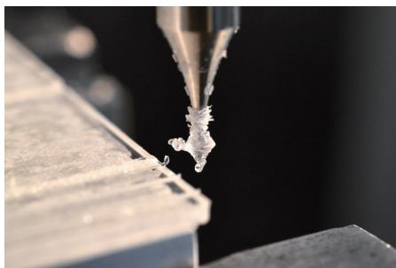
図9 刃先に溶着したポリスチレン樹脂
