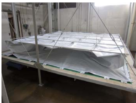
写真5 ガスバッグ 容量41 m 3
