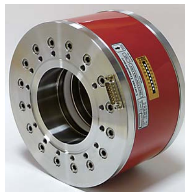
写真3 更新予定の電流モニター
