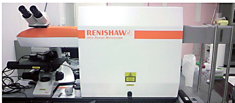
図1 RENISHAW inVia Reflex ラマンマイクロスコープの外観
