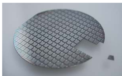
写真3 製作した集積回路 (ウェハ)
