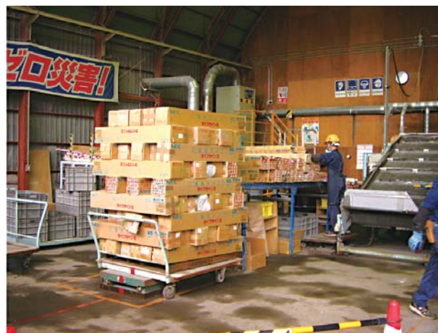
写真2 搬入された蛍光灯と処理工程への投入口
