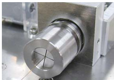
FIB微細加工装置用回転機構
