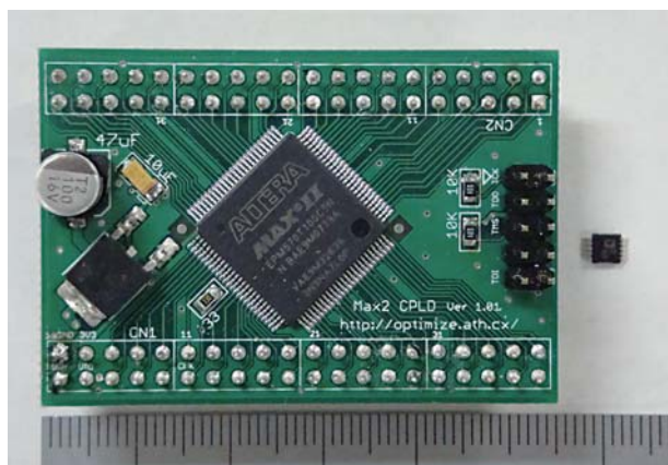
図1 使用したCPLDキット(左)と発振器IC(右)
