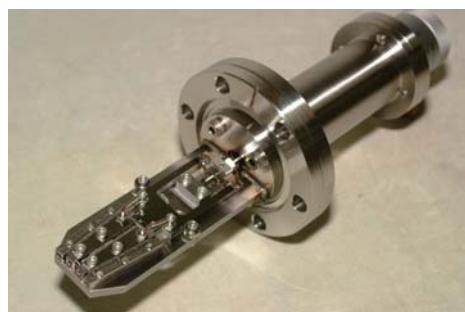
図3 ICF70用スリット全景
