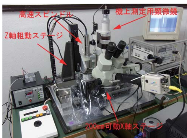
図3 精密CNCフライス装置Ⅱ号機
